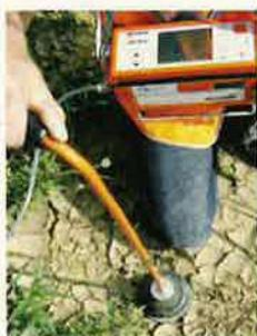
Les émissions passives sont mesurées périodiquement sur l'ensemble de la zone d'enfouissement du C.E.Te.M. afin de s'assurer de l'efficacité du réseau de dégazage.
