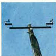
La station météo fournit en permanence le sens et la vitesse des vents, la température, la pression atmosphérique, l'hygrométrie et la pluviométrie.
